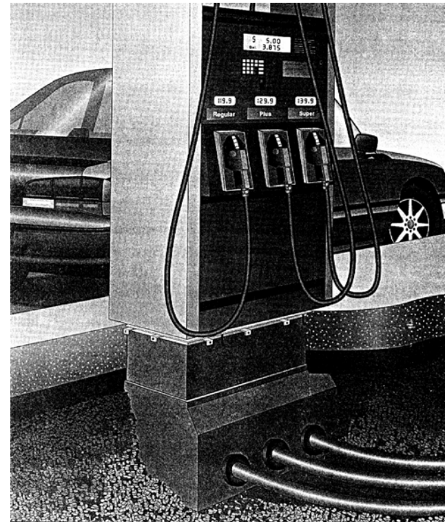
Figura 5.36. Sistema de distribución de combustible. Adaptado de Environ 1995.
